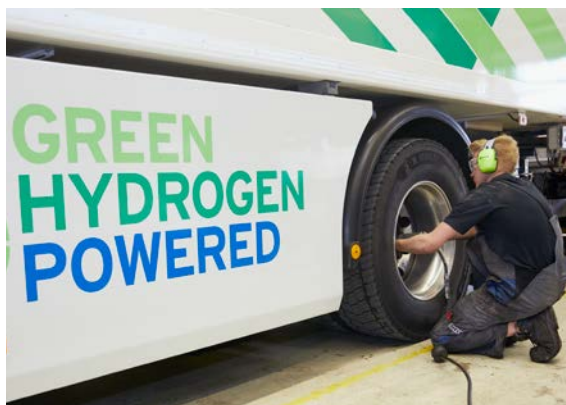
Le niveau de sécurité S 1 est prévu pour tous les travaux, qui nécessitent aucune intervention directe dans le système de gaz.
