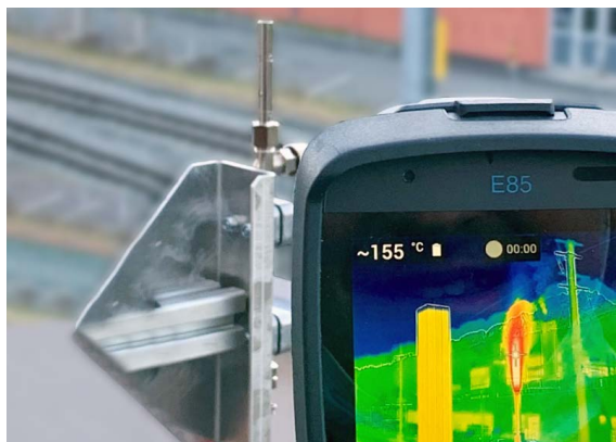
L'hydrogène est incolore et inodore et brûle sous forme de flamme invisible.
